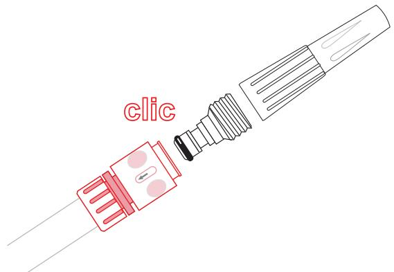
Il est conseillé de changer le joint torique 1 fois /an pour une étanchéité parfaite
