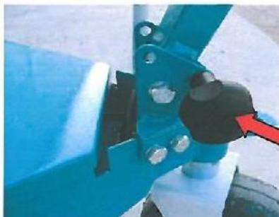
Pour limiter l'encombrement en longueur et/ou en hauteur, le tillon de commandes du Jumbo est réglable en 3 positions : conduite (photos), verticale (permet la conduite avec une longueur contenue à 108 cm) ou basculée sur le coffre (permet de contenir la hauteur à 80 cm pour chargement dans un véhicule)
