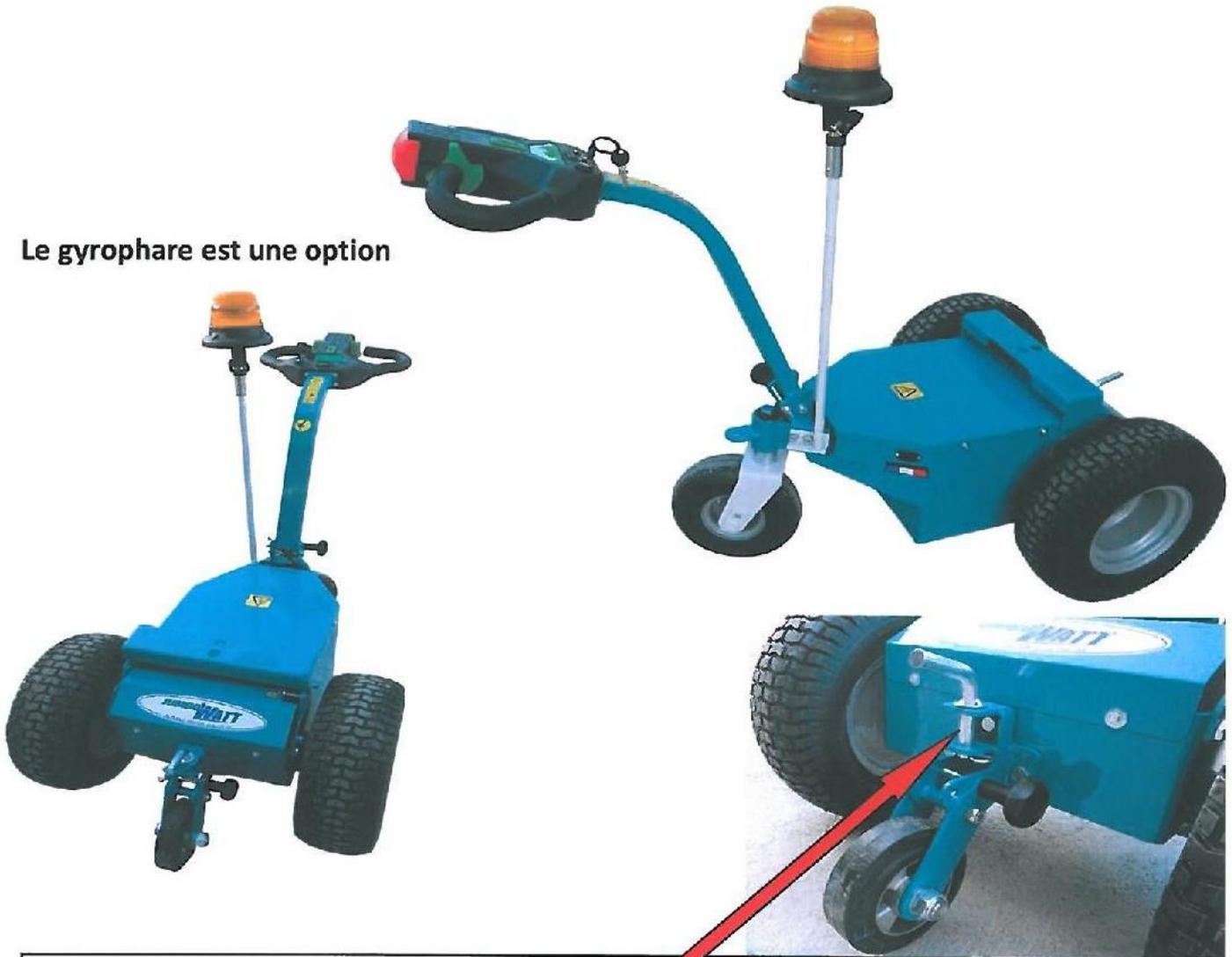
Jumbo est fourni d'origine avec un système de traction à goupilles
